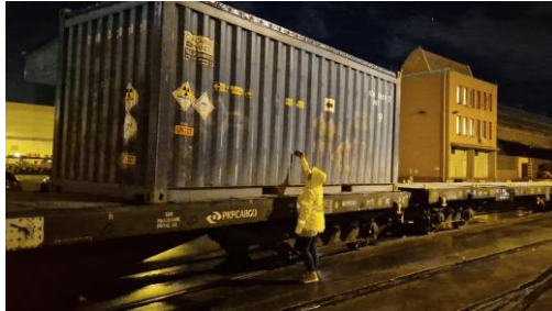
Rysunek 2: Pomiary dozymetryczne pojemnika transportowego (źródło: zasoby własne)
