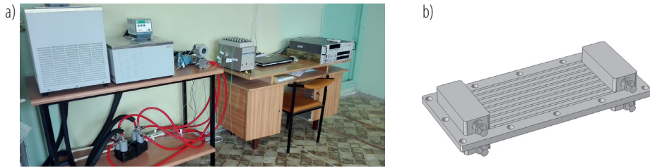
Rys. 1. Stanowisko badawcze (a); schemat płytki z minikanalami i parami kolektorów A, B (b)
