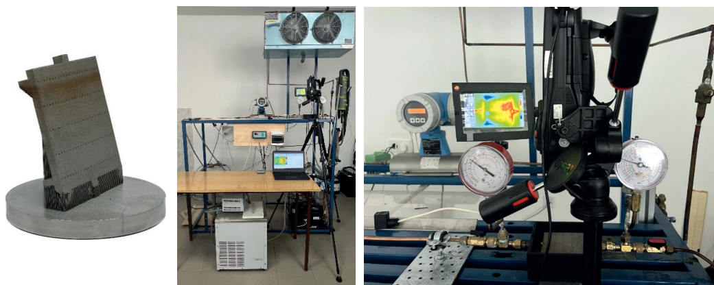
Rys. 2. Kompaktowy wymiennik ciepła wykonany metodą przyrostową (a); widok ogólny stanowiska pomiarowego (b); sekcja pomiarowa (c)
