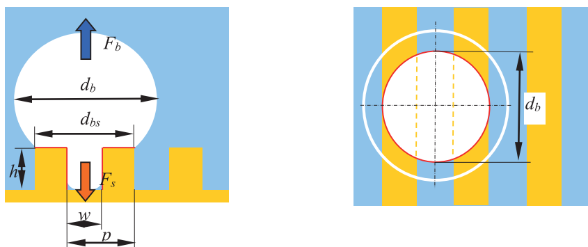
Rys. 5. Formowanie pęcherza na początku fazy odrywania i określenie linii kontaktowej; na czerwono oznaczono linie kontaktowe
