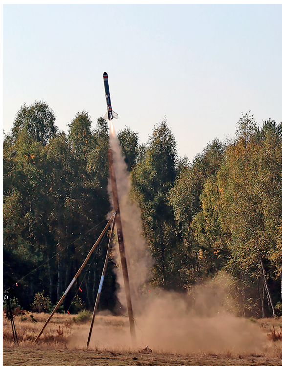
Rys. 1. Start pierwszej w świecie rakiety doświadczalnej napędzanej detonacyjnym silnikiem zasilanym ciekłymi materiałami pędnymi, na poligonie WITU w Zielonce w dniu 15 września 2021.
