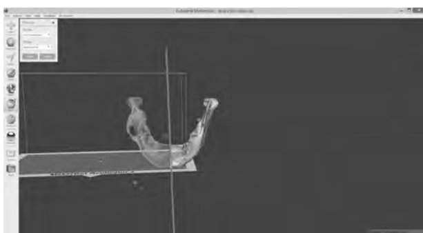
Rys. 6. Projektowanie implantu żuchwy poprzez odbicie lustrzane strony zdrowej
