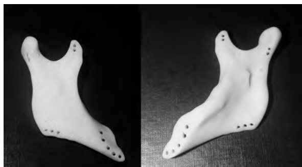
Rys. 8. Gotowy implant indywidualny wykonany technologią druku 3D
