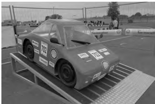
Rys. 1. Pojazd URB16 podczas testu sprawności hamulców w trakcie zawodów Shell Eco-marathon Le Mans 2016 [1]
