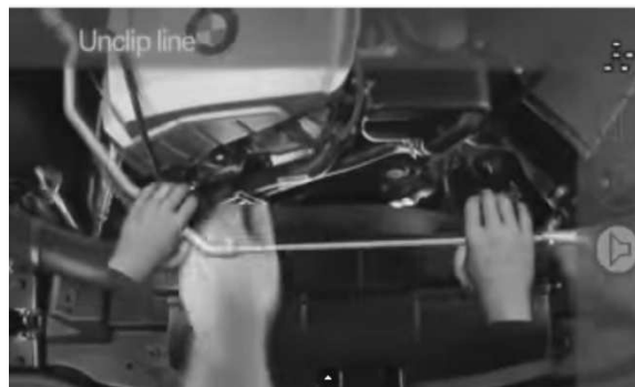
Rys. 8. Przedstawienie działania systemu serwisowego BMW na zasadzie nakładania wirtualnych obrazów będących kolejnymi wskazówkami dla mechanika (źródło: [12])
