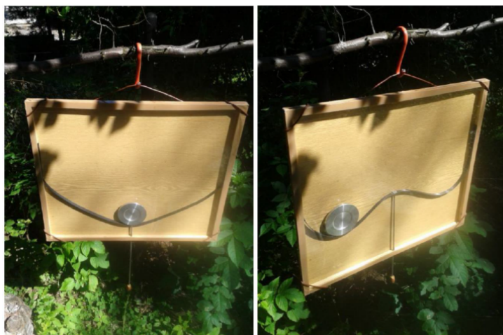
Rysunek 1: Model spontanicznego łamania symetrii zwierciadlanej względem pionowej płaszczyzny połowiącej tablicę [5]
